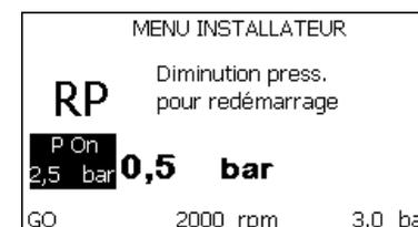
Figure 18 : Réglage de la pression de redémarrage
