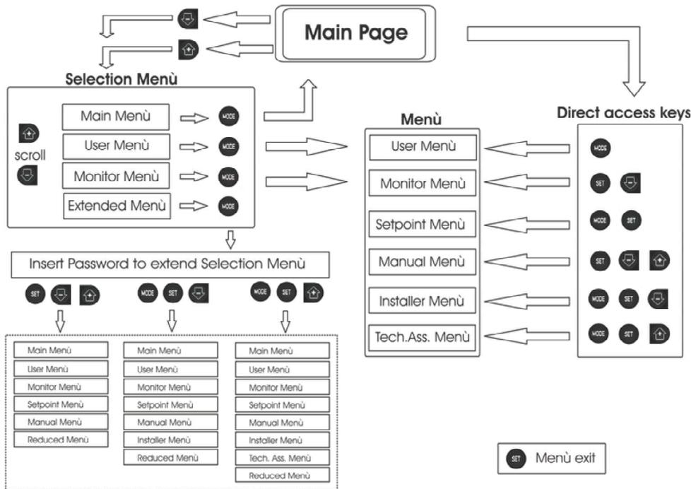
Figure 15: schéma des accès possibles au menu
